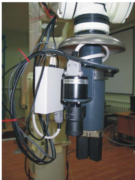
Рис. 4. Рабочий орган ПР в составе ФМС: видеокамера СТЗ, СМД, захватное устройство
