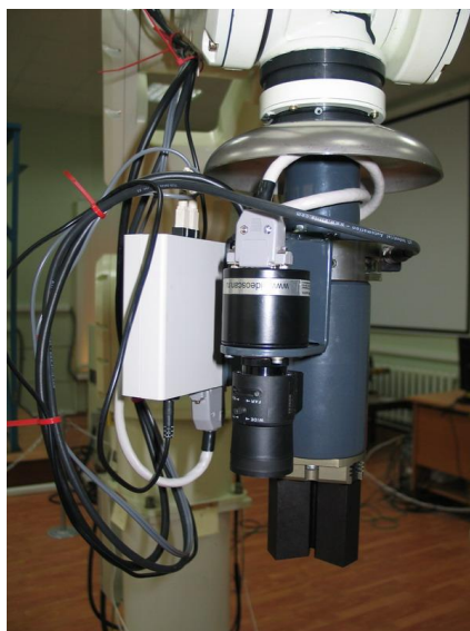
Рисунок 4 – Рабочий орган ПР в составе ФМС: видеокamera СТЗ, СМД, захватное устройство
